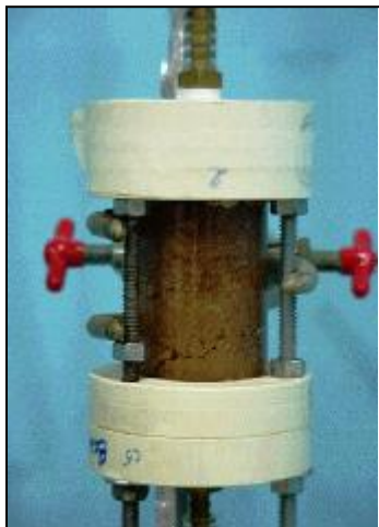
Figura 6: Coluna de 2,2 cm de comprimento e diâmetro de 3,5 cm preenchido com o solo contaminado utilizada nos ensaios de redução (FRANCO, 2008).
