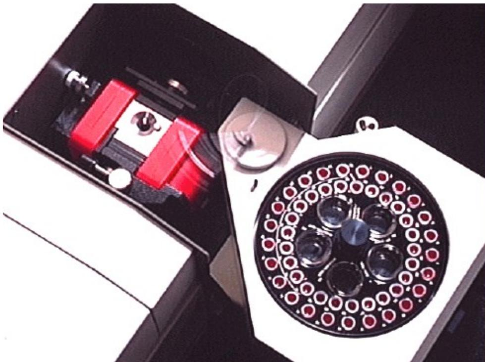
**Figura 2.1:** Espectrômetro de Absorção Atômica com Forno de Grafite.
