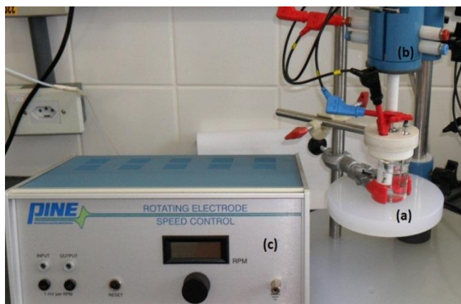
Figura 5 - Montagem para realização de voltametria hidrodinâmica, onde (a) é a célula eletroquímica, (b) é o motor de rotação e (c) é o controlador de rotação.
