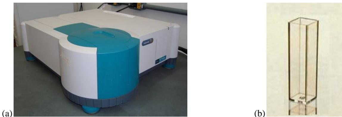
**Figura 4.1:** Espectrofotômetro UV/Visível da Varian, modelo Cary 50 Conc (a) e Cubeta de quartzo (b)
