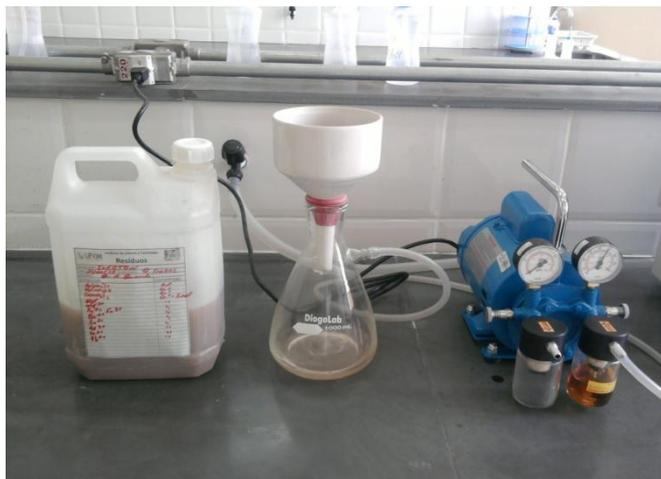
**Figura 4:** Sistema de filtração do resíduo para remoção da fração sólida.
