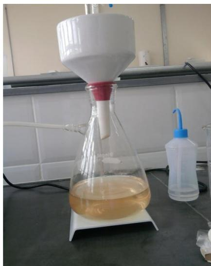
**Figura 8:** Detalhe do sistema de filtração e coloração do sobrenadante após a segunda precipitação.
