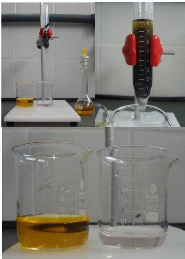
**Figura 7-Experimentos demonstrando as amostras de cromato de potássio sendo percoladas pela coluna neutra.**
