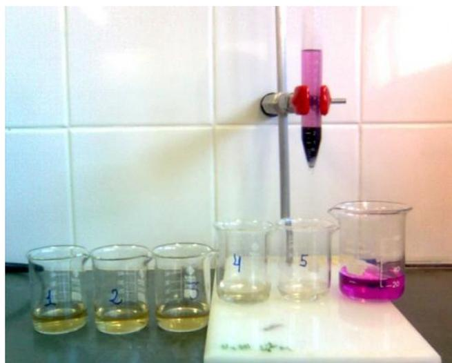
**Figura 17-Experimento com a coluna tratada com hidróxido de sódio com posterior percolação da solução contendo permanganato de potássio.**
