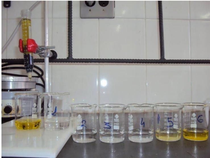
**Figura 9-** Experimento com a coluna tratada com ácido sulfúrico com posterior percolação com cromato.
