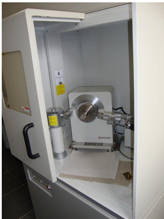
Figura 2: Difratômetro da Shimadzu modelo XRD 6000 utilizado para a caracterização *ex-situ* do ADE
