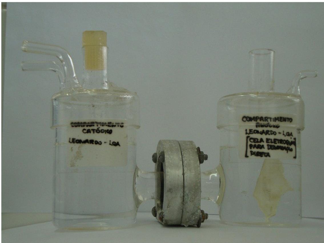
**Figura 4: Célula eletroquímica de dois compartimentos**
