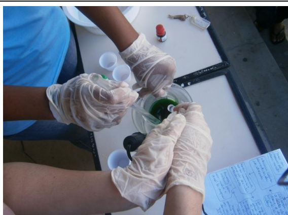
Figura 1 – Imagem da realização do experimento: adição de gotas de solução de bateria durante aquecimento.
