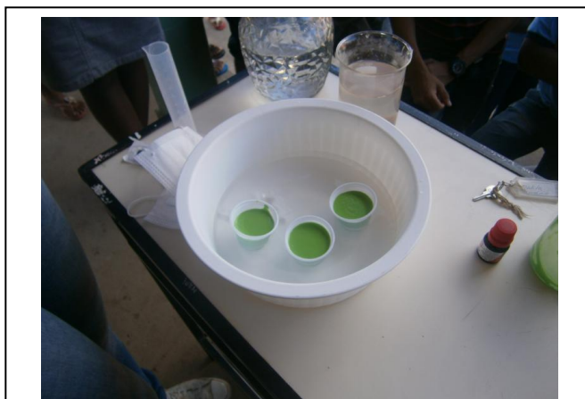
Figura 13 – Imagem do plástico obtido sob resfriamento em banho de água gelada. Os copinhos descartáveis foram utilizados como molde para dar forma ao plástico.
