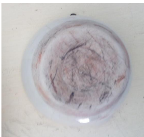
Figura 7: Almofariz de porcelana para teste do traço.
