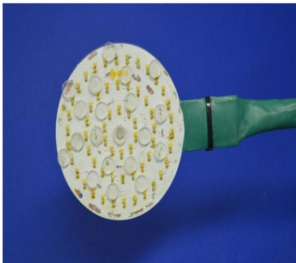
FIGURA 10- Unidade emissora de luz com 30 pares de LEDs.
