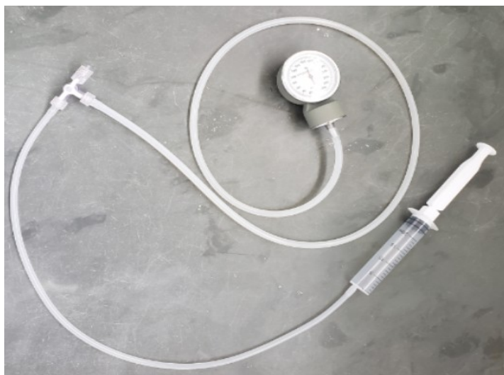
FIGURA 1: Kit de calibração (manômetro para esfigmomanômetro, seringa de 20 mL e Three way conectados por tubos de silicone).
