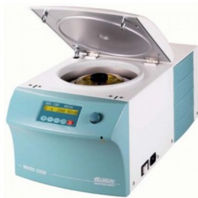
Figura 1: Centrífuga refrigerada Hettich Zentrifugen, modelo MIKRO 220R
