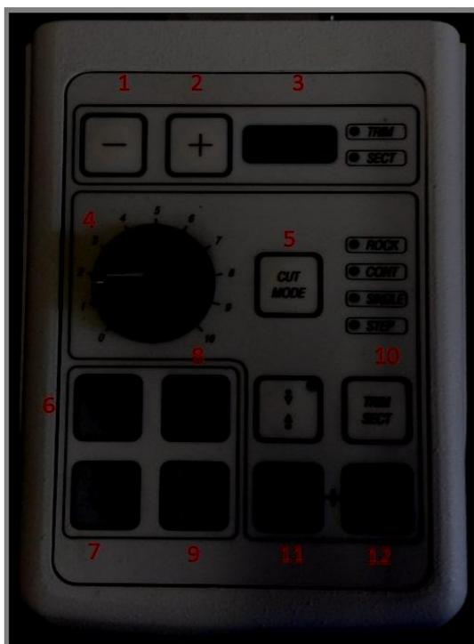
Figura 2: Controle para confecção de cortes automáticos
