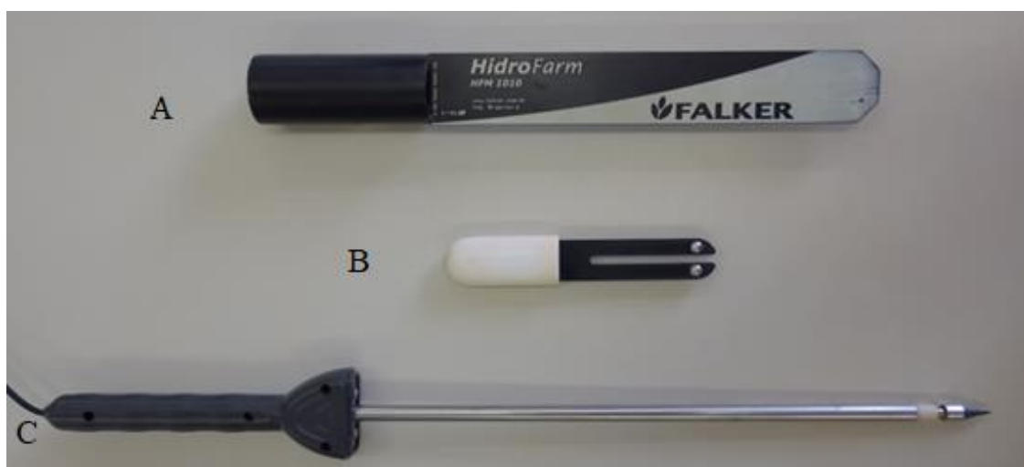
Figura 1. Sensores de umidade do solo utilizados. (a) Sensor HidroFarm; (b) Sensor Vergtrug Care; (c) Sensor PMS710.
