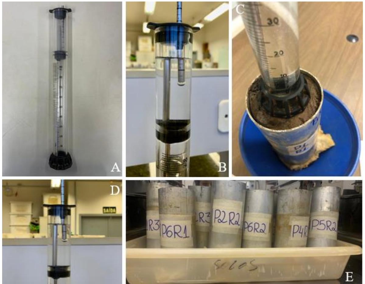
Figura 4 - Equipamento utilizado. Fonte: Arquivo pessoal do autor, 2023. A. Infiltrômetro Mini Disco. B, C e D. Testes de infiltração utilizando o infiltrômetro. E. Cilindros contendo as amostras indeformadas
