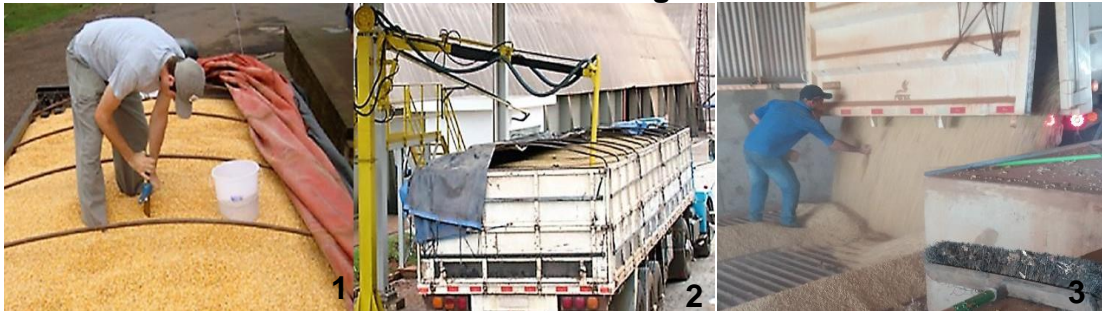
Figura 2: 1- Coletor manual. 2- Coletor Pneumático. 3- Amostragem em fazenda na moega.
