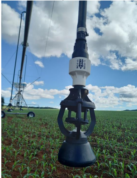
Figura 2 - Aspersor de irrigação i-wobbler utilizado no equipamento pivô central implantado na Fazenda Galho, Unai-MG.
