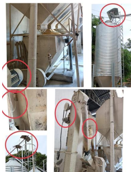
Figura 2 - Motores utilizados na propriedade para a preparação e transporte da ração para os suínos.
