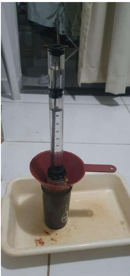
Figura 5: Teste de Infiltração de água e condutividade hidráulica em amostras de solo saturadas, utilizando o infiltrômetro mini disco.
