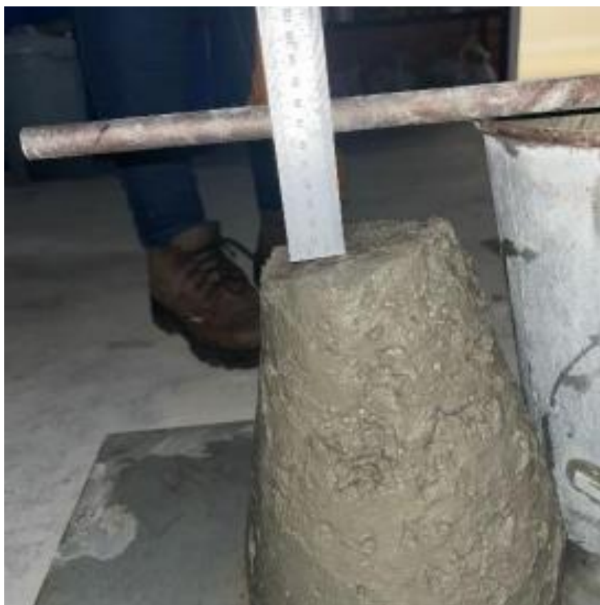
Figura 12 - Ensaio de slump test e moldagem.
