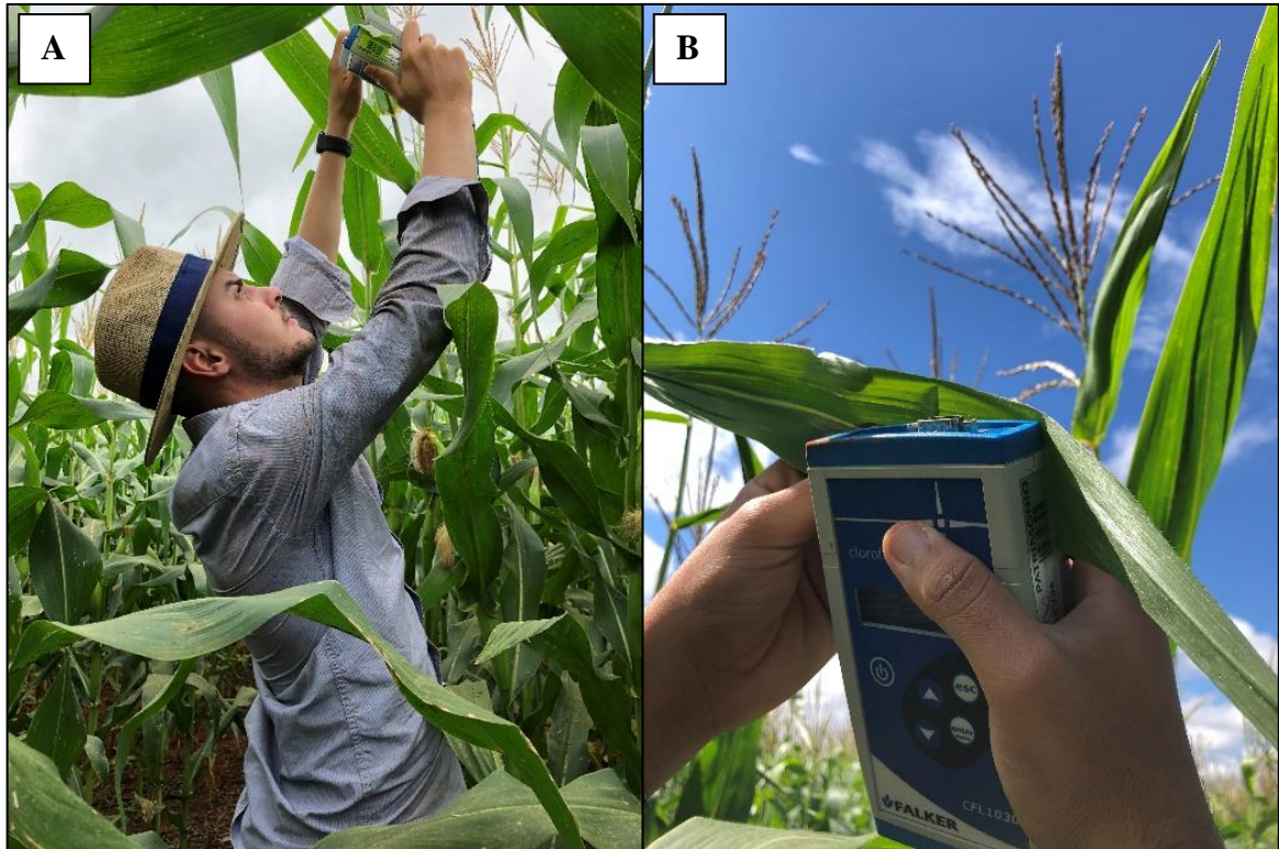
Figura 26. A e B: Avaliação dos teores de clorofila a e b utilizando um clorofilog Falker tirando a medida no centro da folha bandeira. UFVJM, Unai – MG, Brasil (2021).
