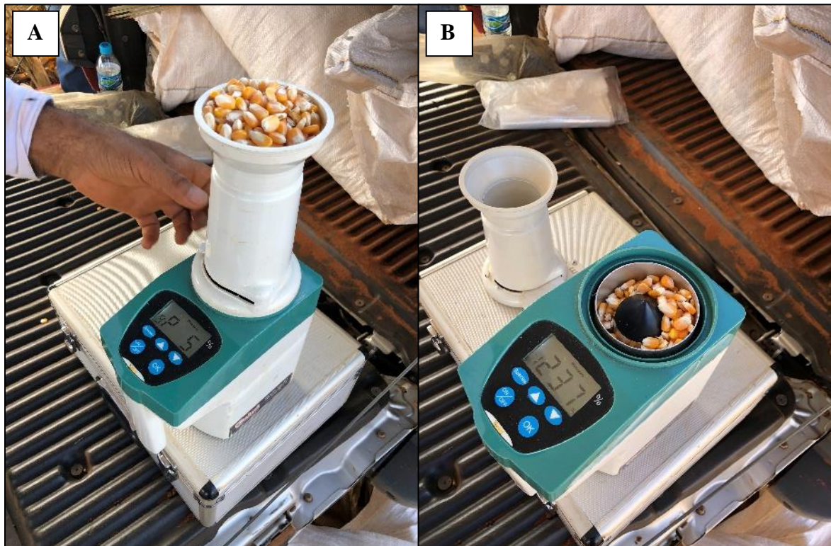
Figura 21. A e B: Medição de umidade realizada logo após a pesagem dos grãos utilizando um medidor de umidade digital. UFVJM, Unaí – MG, Brasil (2021).
