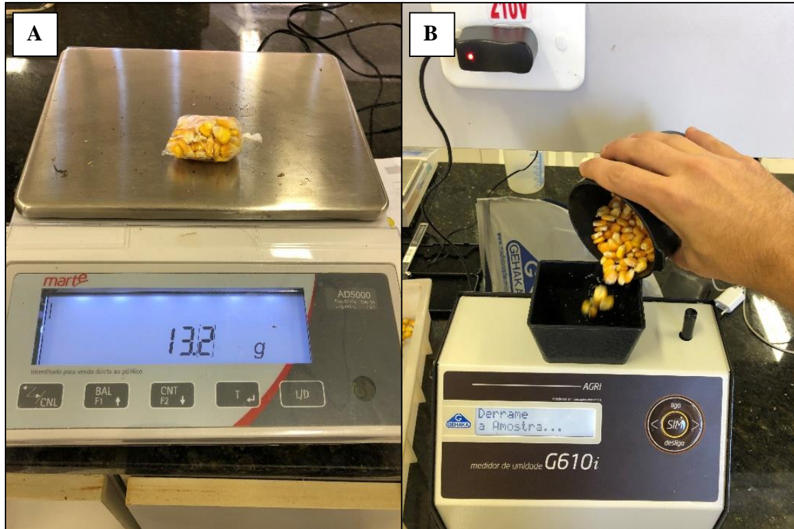
Figura 28. A: Pesagem de 50 grãos para avaliação da massa de mil grãos (esquerda) e medição de umidade para conversão da massa para 13% (direita). UFVJM, Unai – MG, Brasil (2021).
