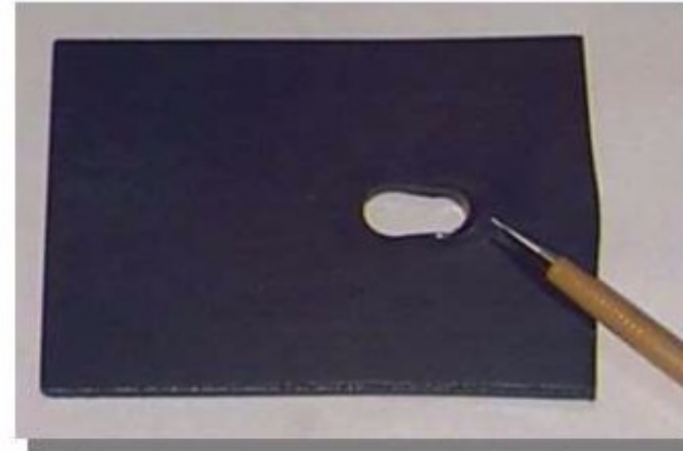
Deformação excessiva do furo
