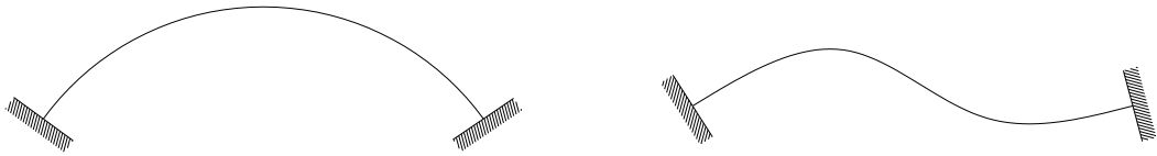
Figura 6 – Vigas curvas e com mudança de direção são solicição por torção.
