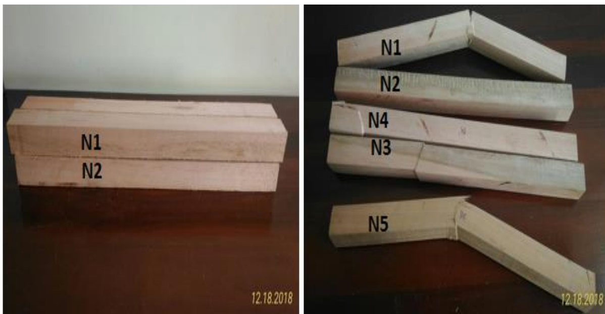
Figura 40: Corpos- de- prova 40x40x600 mm antes (esquerda) e após (direita) ensaios.
