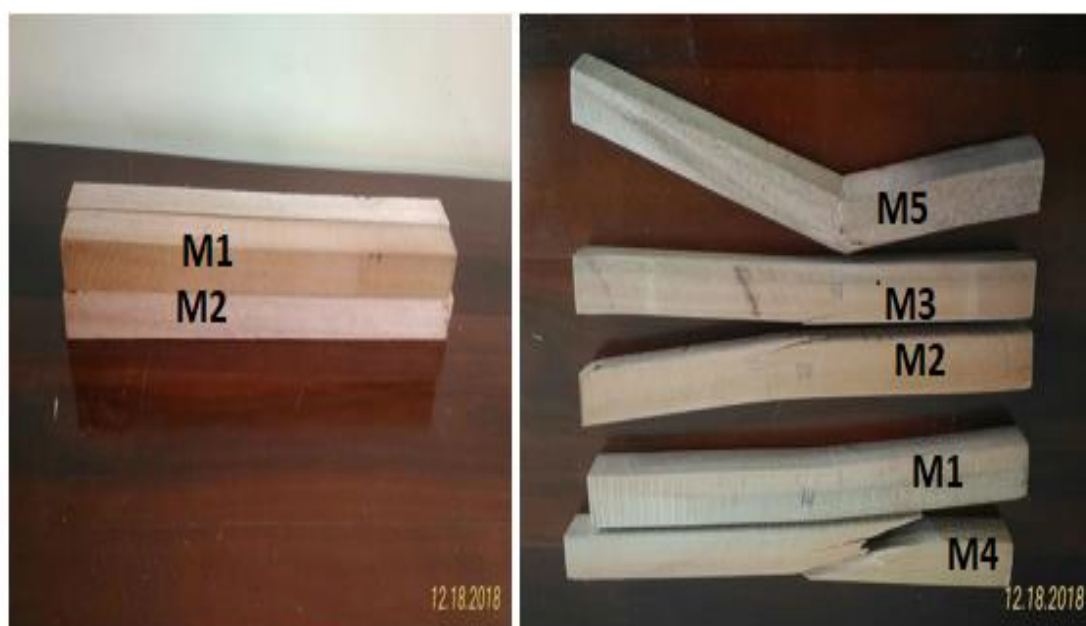
Figura 39:Corpos- de- prova 30x30x450 mm antes (esquerda) e após (direita) ensaios.
