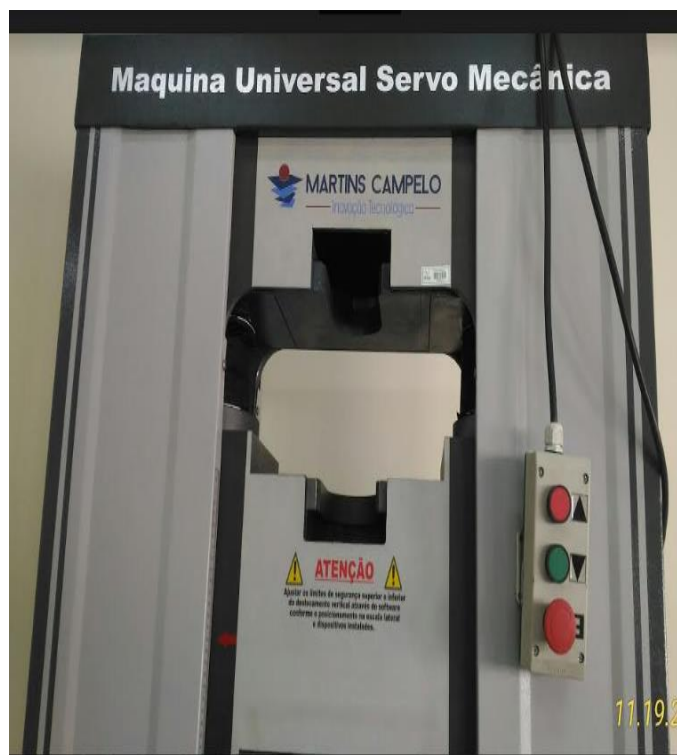
Figura 09: Máquina Universal de ensaios Martins Campello Ltda, com capacidade de 150 kN.
