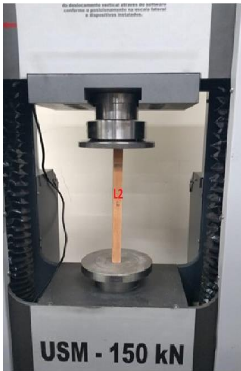
Figura 10: Máquina universal, o corpo-de-prova e sua preparação para o ensaio de compressão.
