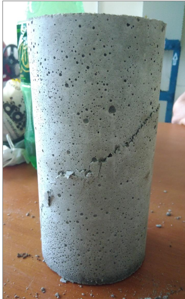
Figura 22 – Ruptura cisalhada lateral, ângulo de 45^\circ
