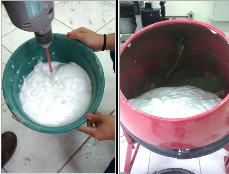
Figura 10 – Geração de espuma e sua adição ao concreto
