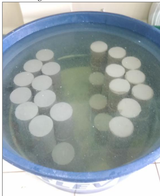
Figura 13 – Cura do Concreto
