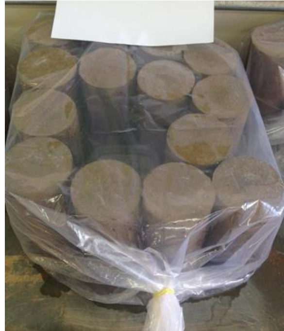
Figura 10 - Armazenamento dos corpos de prova simulando ambiente de cura
