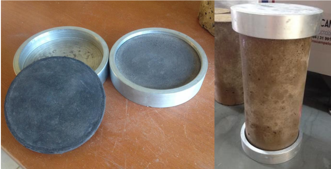
Figura 14 - Estrutura instalada no corpo de prova precedendo o ensaio de compressão
