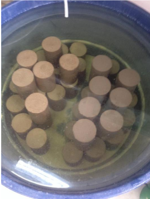
Figura 9 - Imersão dos corpos de prova em solução de água e cal
