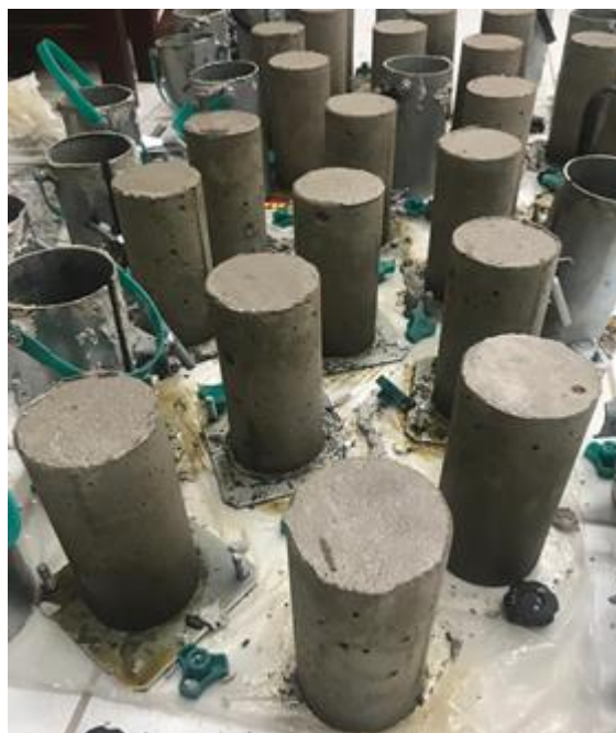
Figura 8 - Desmolde dos corpos de prova após 24 horas da execução do traço
