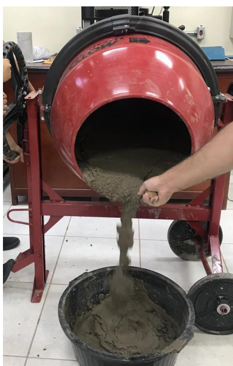
Figura 11 - Betoneira em uso
