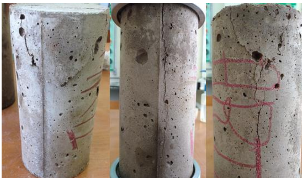
Figura 15 - Tipos de ruptura
