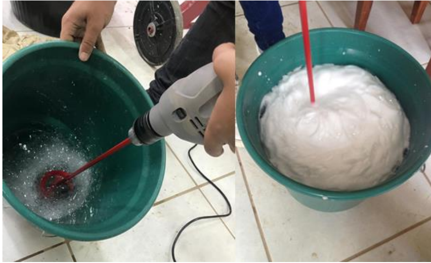
Figura 12 - Preparação da espuma por intermédio de um agitador mecânico
