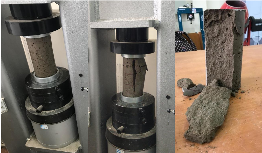
Figura 13 - Ensaio de resistência à compressão
