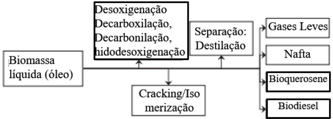
Rota de hidroprocessamento para conversão de óleos vegetais em bioquerosene (WHY, et al., 2019)
