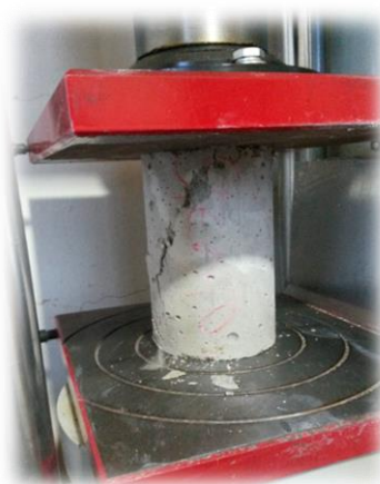
Figura 2 – Ensaio de Rompimento do Corpo de Prova.
