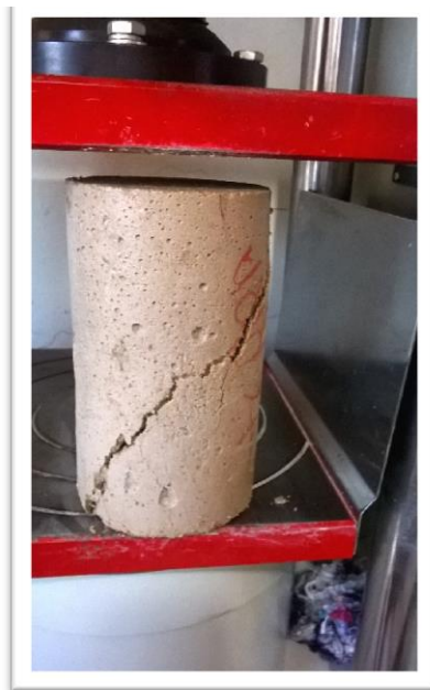
Figura 1 – Ensaio de Rompimento do Corpo de Prova.
