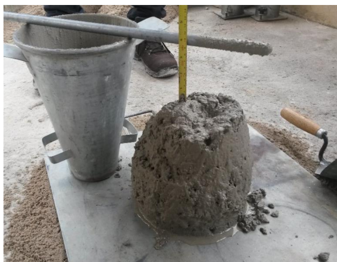
Figura 2 – Slump Test Concreto com areia natural.
