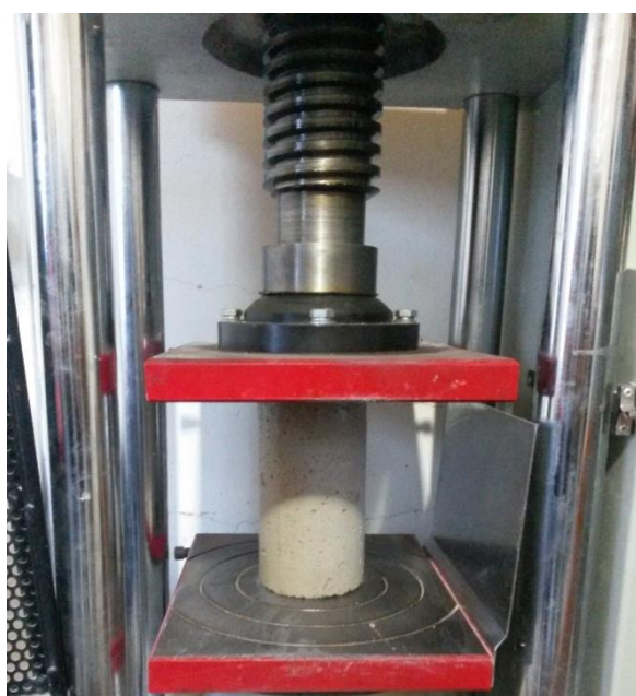
Figura 3 – Ensaio de Rompimento do Corpo de Prova.
