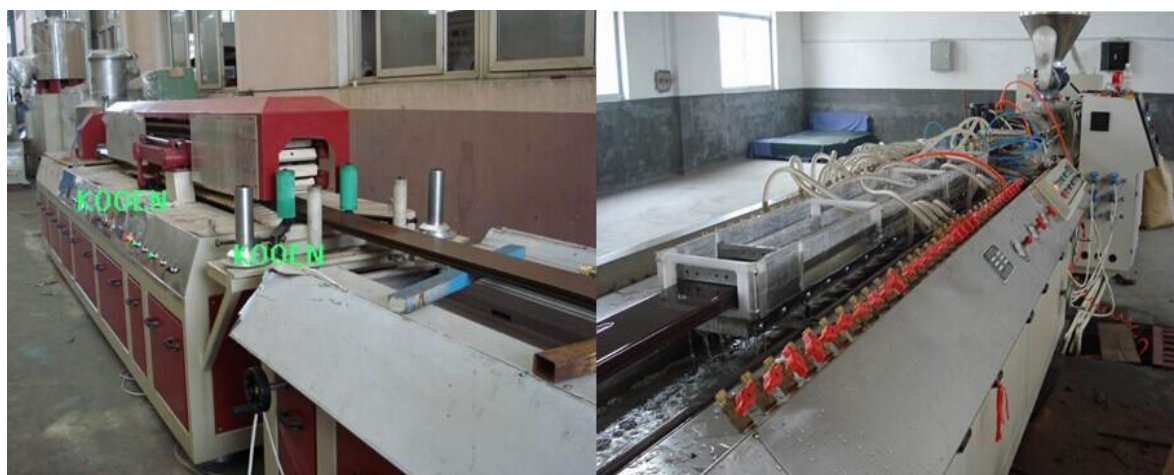
Figura 2 - Processo de Fabricação da Madeira Plástica
