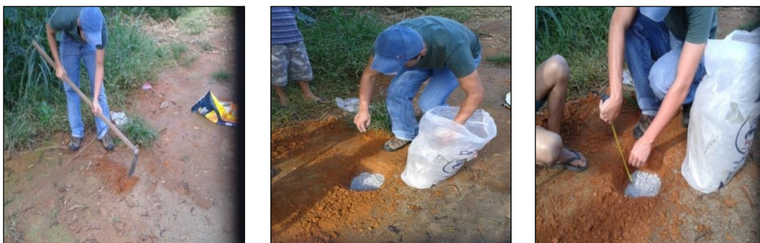
Figura 2: Etapas do teste de percolação: Medição com cronômetro e escala graduada em cm. Preenchimento com água. Repetindo a operação.
