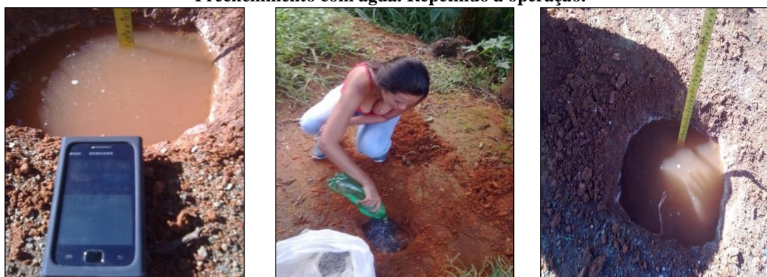
Figura 2: Etapas do teste de percolação: Medição com cronômetro e escala graduada em cm. Preenchimento com água. Repetindo a operação.
