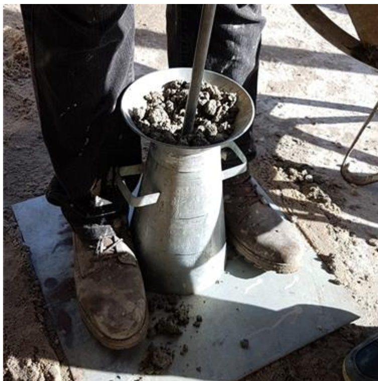
Figura 18 – Socamento do concreto convencional
