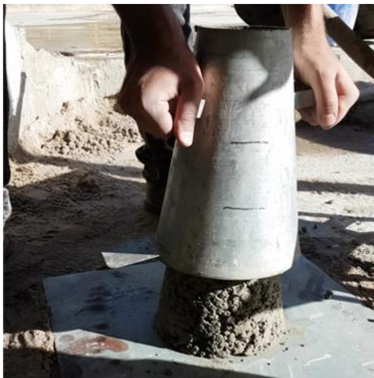
Figura 19 – Retirada do cone - concreto convencional
