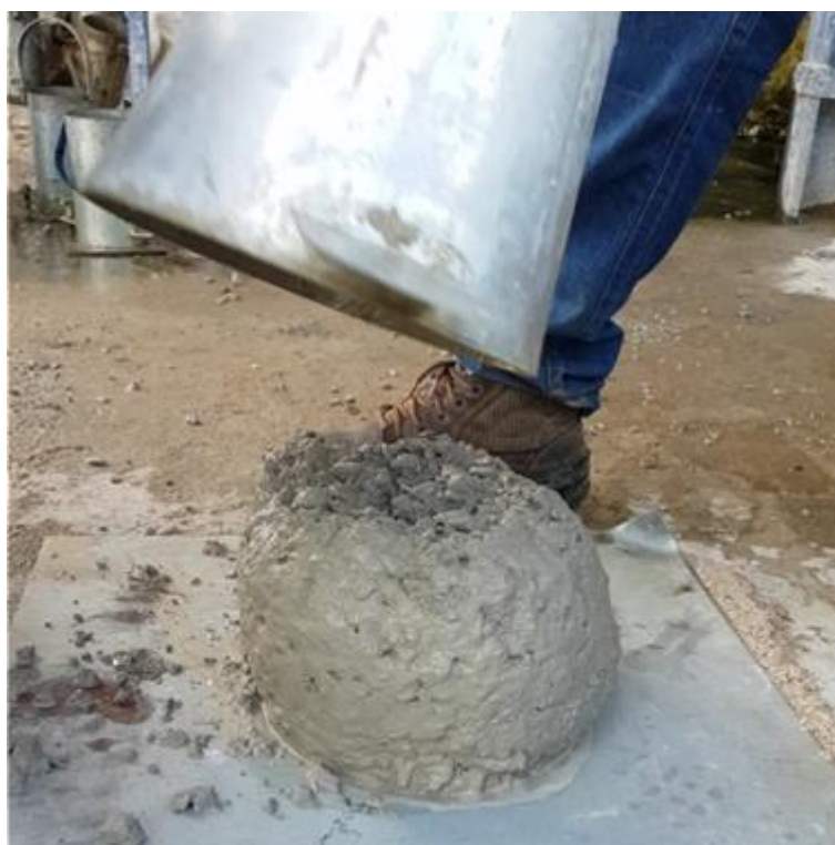
Figura 20 – Retirada do cone - concreto auto-adensável
