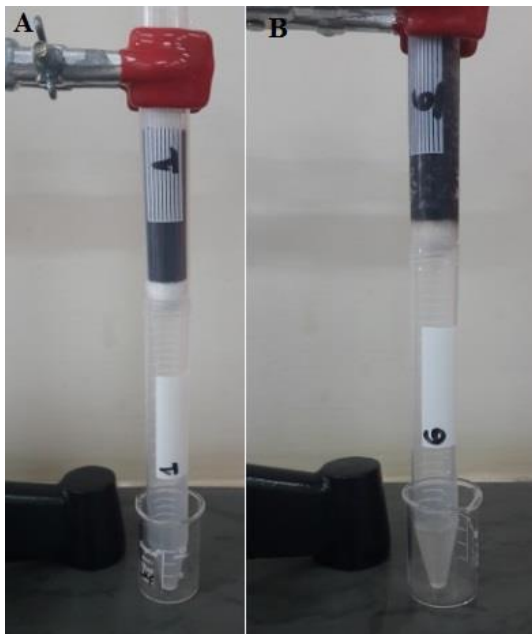
Figura 5 – Estrutura e Filtração apenas com Carvão Ativado
