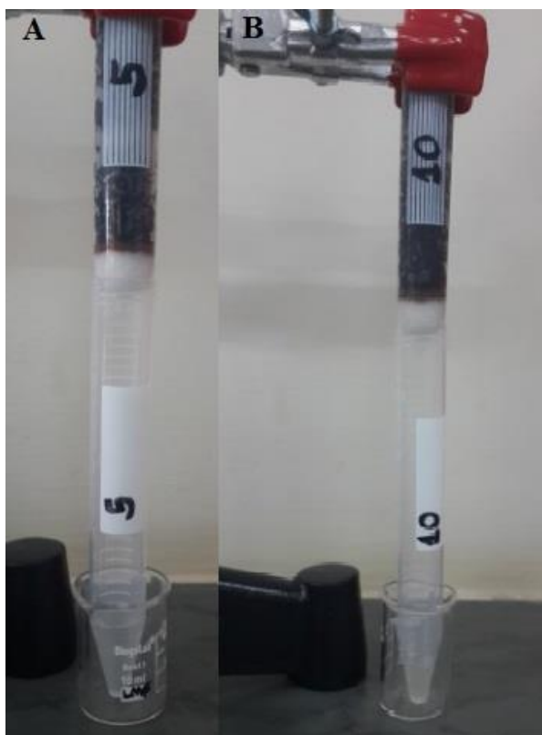
Figura 6 – Estrutura e Filtração com 2 mm de oxidróxido de Ferro e Carvão Ativado
