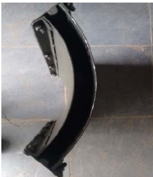
Figura 3- Forma do molde para produção de bloco de meia-lua
