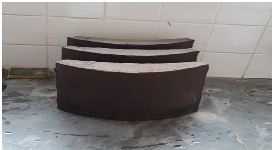
Figura 7 – Bloco de solo-cimento em formato semicircular para controle erosão
