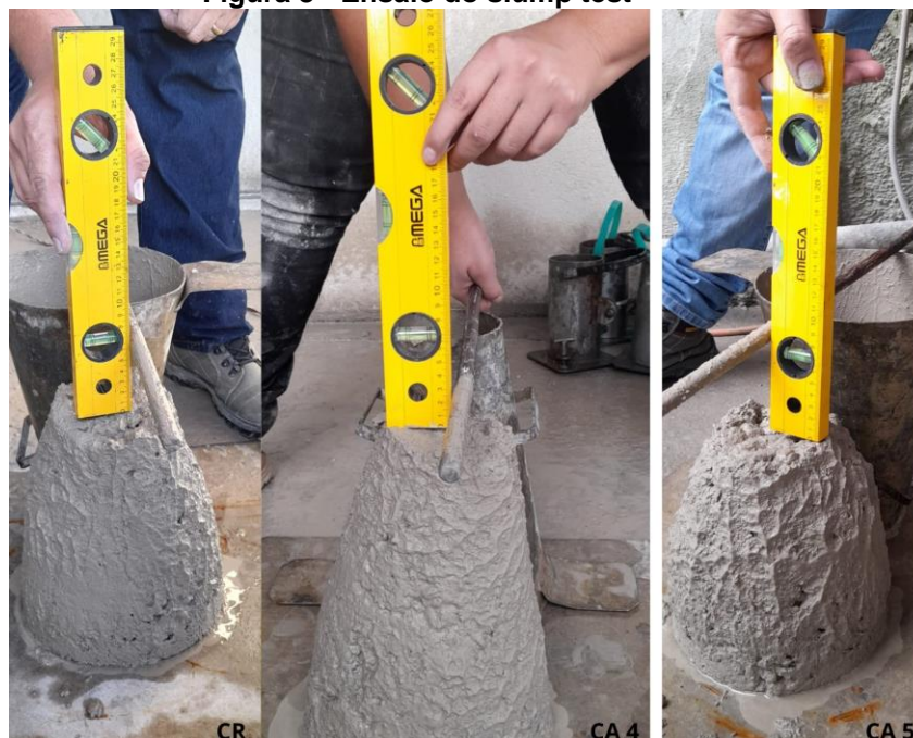
Figura 3 - Ensaio do slump test
