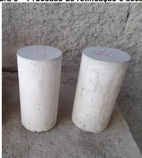
Figura 5 – Processo de retificação e secagem
